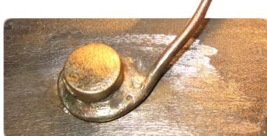
SnakeBite® – Новое соединение для подключения одножильных анодов без кабельных наконечников. Согните проволоку вокруг цилиндрического шаблона плоскогубцами и припаяйте к трубопроводу.
